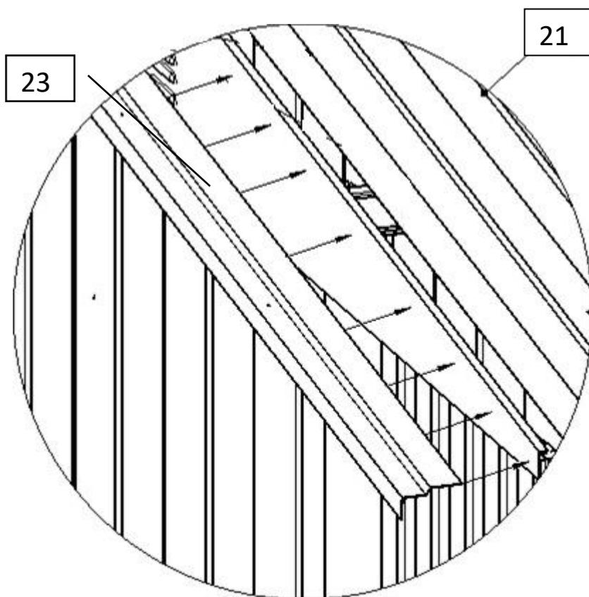
Крепим декоративные уголки (поз.31) на край крыши саморезами-сверлами (поз. 36) через одну волну, совмещая края уголков с краем элемента доборного крыши (поз. 23).
