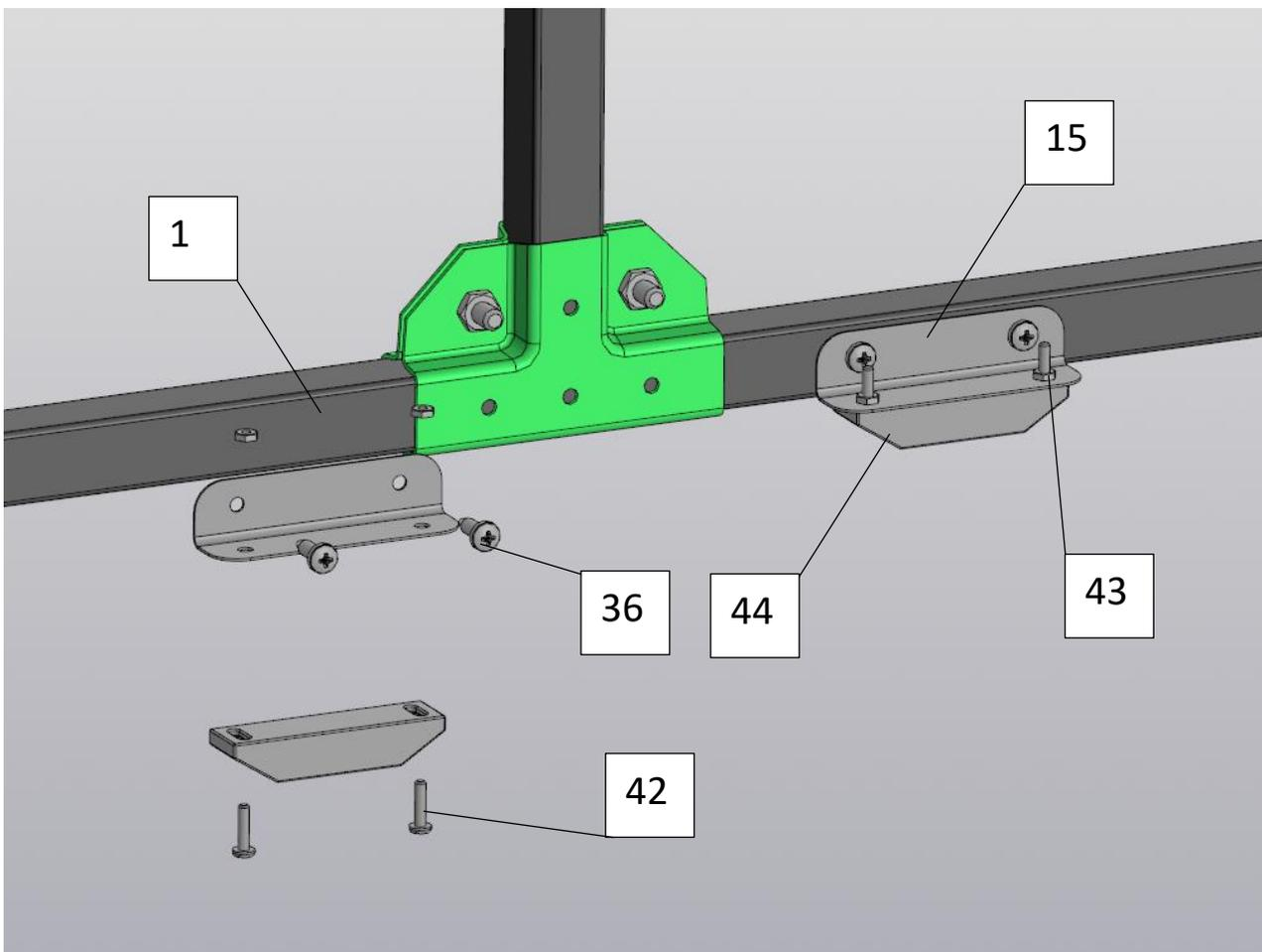
На трубу поз.1 в основании дверного проема устанавливаем порог поз.26 закрепляем винтами поз.36 через перфорированные отверстия в пороге
