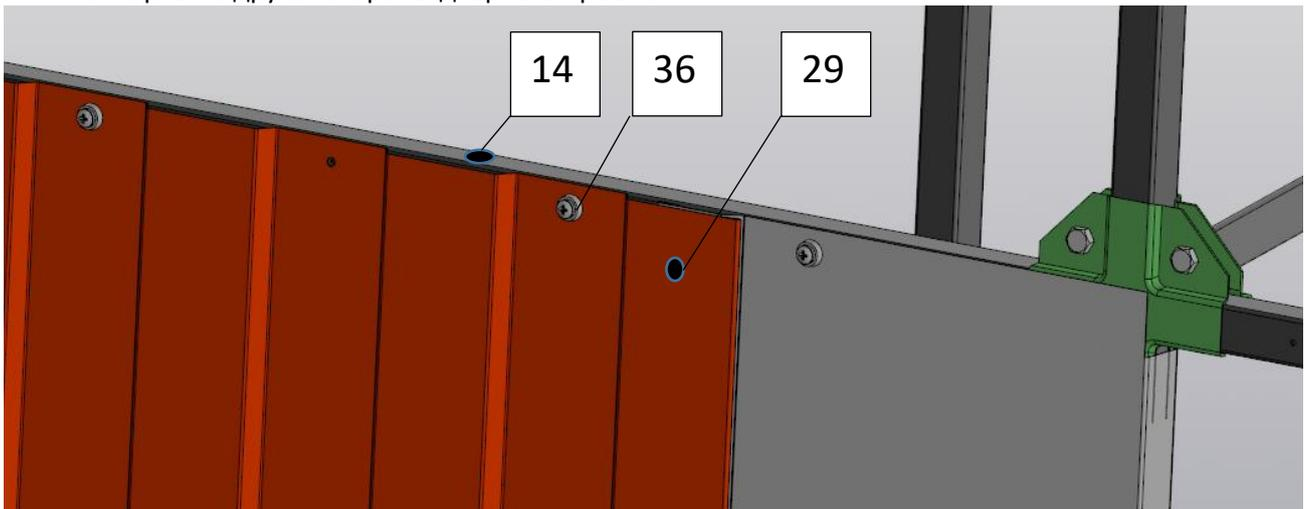
С внутренней стороны каркаса по левую и правую сторону от обойма Т поз.46 узла каркаса «D» устанавливаем на трубу поз.1 Кронштейн магнитной защелки поз.15 (допускается в упор торцами с обоймой поз.46). Плоскость кронштейна поз.15 должна быть совмещена с нижней плоскостью трубы поз.1. Кронштейн поз.15 должен быть зафиксирован на трубе поз.1 винтами поз.36. Повторить операцию для второго кронштейна.
