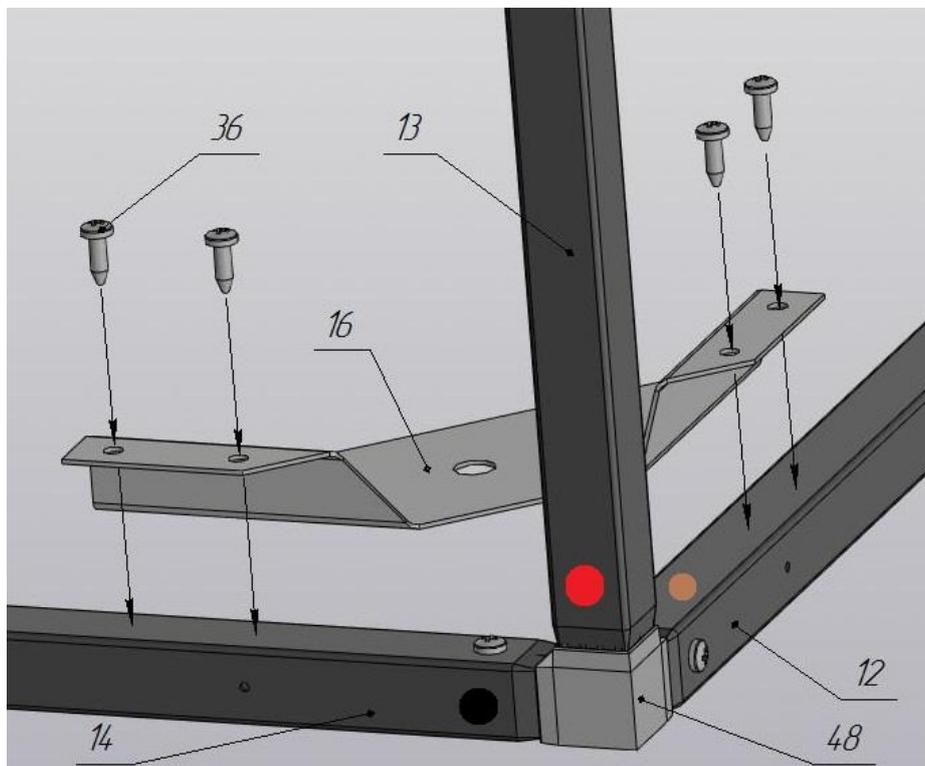
Необходимо произвести крепление сарая к фундаменту через специальные отверстия, предусмотренные в фиксаторе внутреннего угла поз.16 анкерными болтами или другим способом (данные крепления не входят в комплект поставки, решение по способу крепления к фундаменту остается за Вами).
