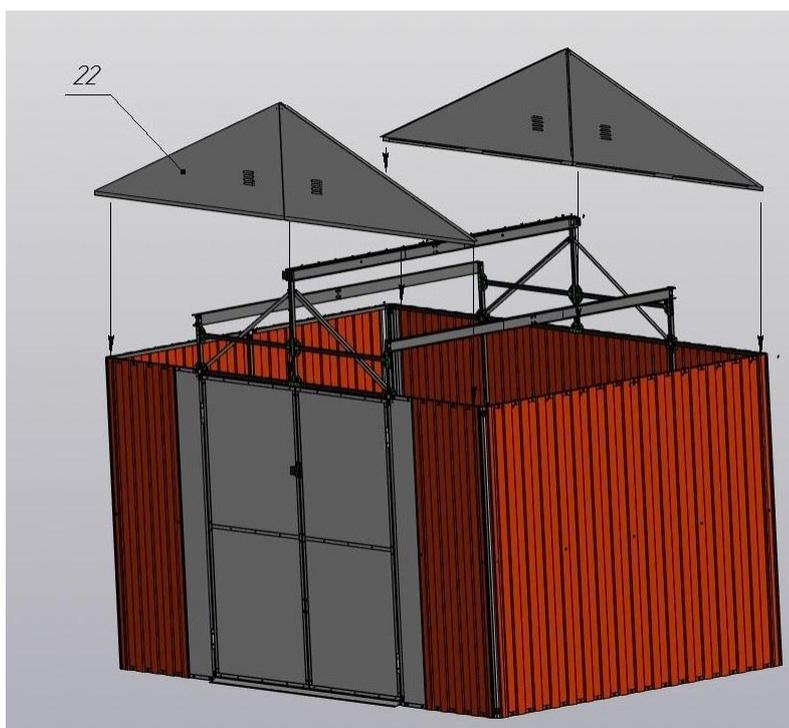
Устанавливаем фронтоны на каркас и прикручиваем к трубе (поз. 1) саморезами-свёрлами (поз.36) через предварительно подготовленные отверстия во фронтоне.
