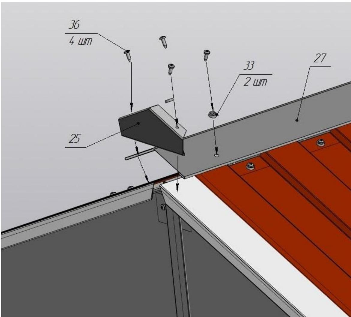
**3.10. На все 4 угла кровли домика устанавливаем пластиковые уголки (поз.28)**
