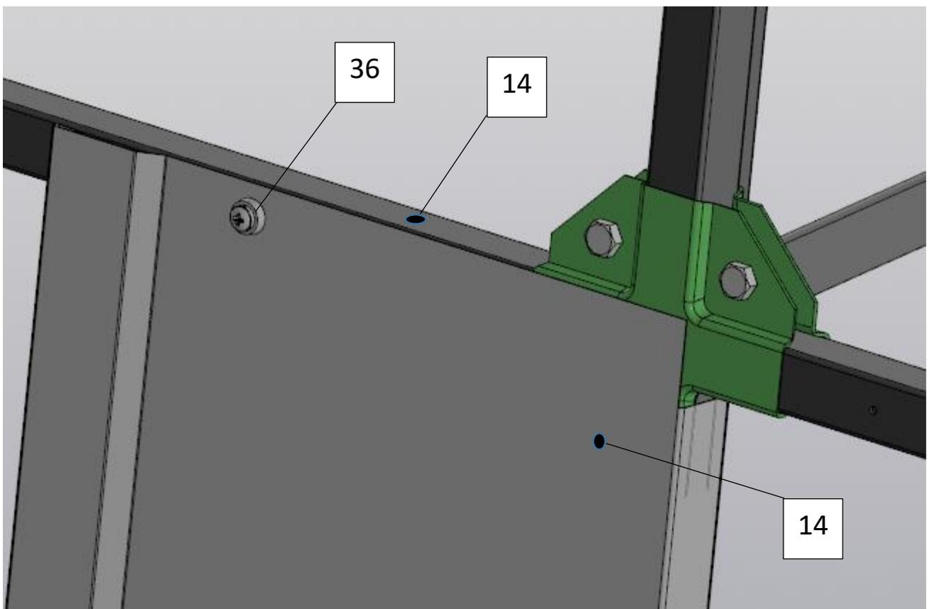
Далее устанавливаем Стенку с подгибом поз.29. (подгиб должен быть со стороны дверного добора поз.20) совмещая отверстия перфорации стенки поз.29 с перфорацией отверстий в трубах поз. 14. Предварительно крепим стенку поз.29 на 4 винта поз.36 ближе к дверному проему. Операцию повторяем с другой стороны дверного проема.
