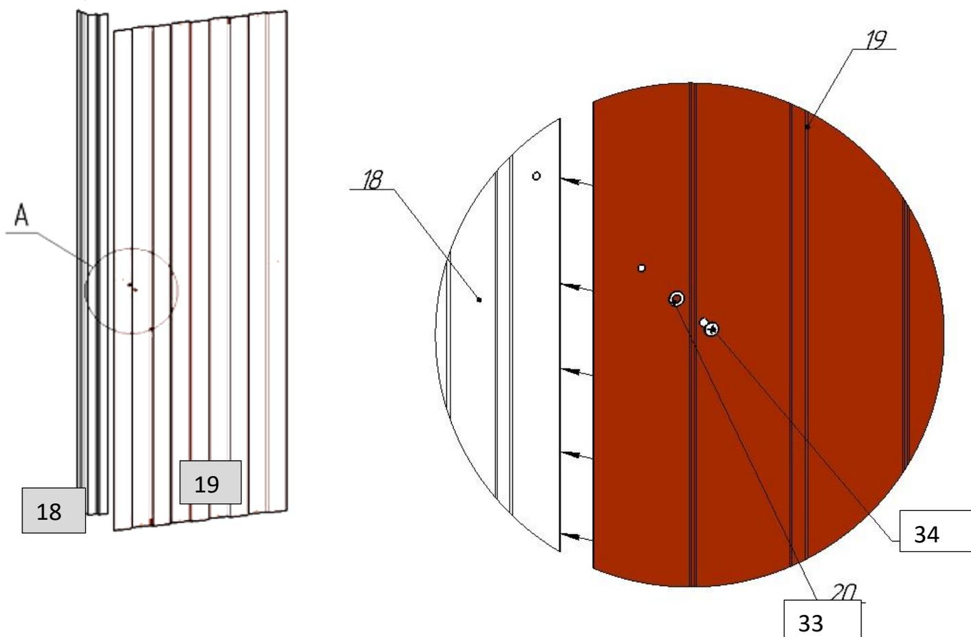
Примечание: стеновой профлист(поз.19) крепится поверх уголка (поз.18).
