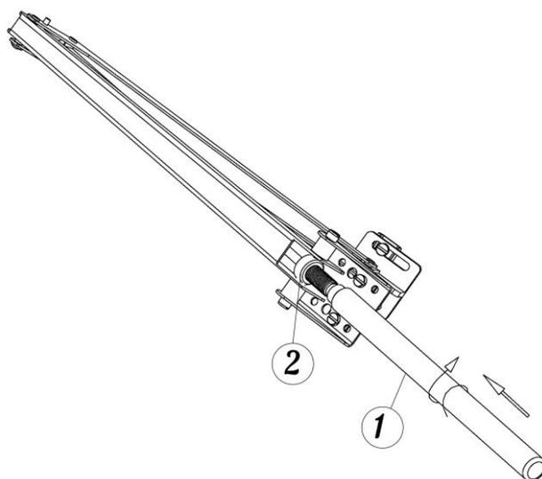
8. Поворачивая цилиндр(1) вокруг своей оси в держателе цилиндра Вы можете регулировать начальную температуру открывания/закрывания форточки. При повороте по часовой стрелке механизм открывает форточку раньше и больше, против часовой – позже и меньше. Один полный поворот соответствует приблизительно 0,5°C.
